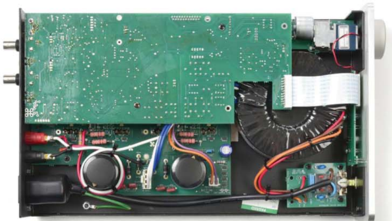
DOPPELDECKER: Die Digitalplatine belegt alleine die obere Etage im kompakten, aber leistungsfähigen XM5. Der Vollverstärker verwendet einen 200-VA-Ringkerntransformator.
